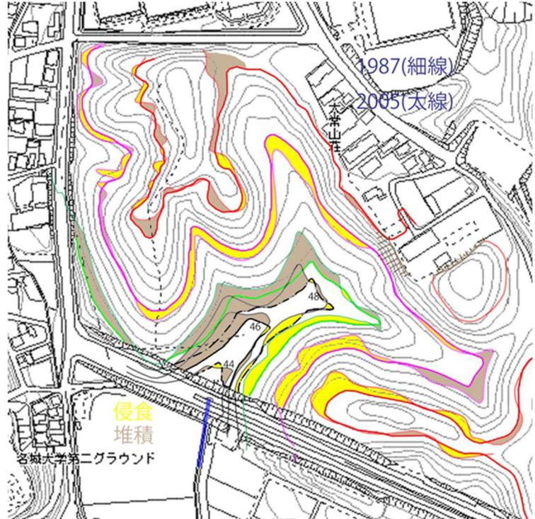
図4 等高線の高度変化と侵食・堆積の推定
